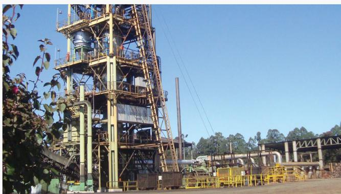
Carboval é um reator vertical de carbonização contínua que transforma madeira em carvão vegetal, sem liberação de metano ou de monóxido de carbono. Em apenas 16 horas, é capaz de produzir 22 toneladas de carvão de excelente qualidade, com aproveitamento de 95% da energia da matéria-prima. Substitui o forno retangular convencional, cujo ciclo de produção leva 16 dias para gerar 50 toneladas com aproveitamento energético de, no máximo, 55%.
